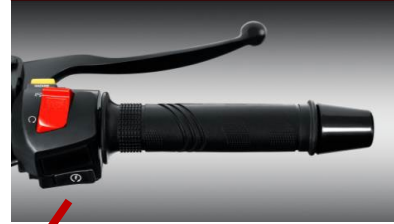
Feux de détresses
